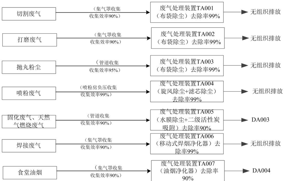
图 4-1 废气收集及处置系统示意图
