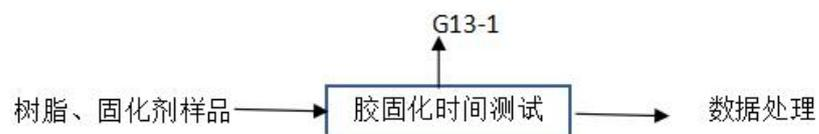
图 2-16 胶固化时间实验流程图
