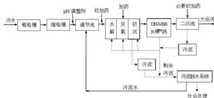
图 4-2 污水处理厂处理工艺图
