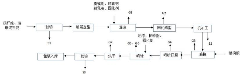
图 2-19 现有六期项目生产及产污环节示意图 (在建)
