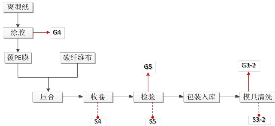
图 2-8 现有五期项目碳纤维预浸料产品生产及产污环节示意图
