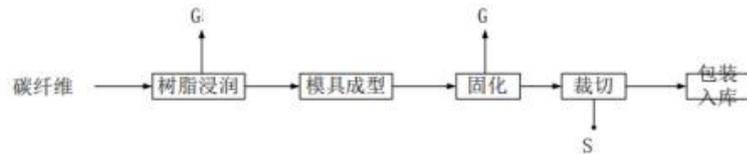
碳纤维拉挤板生产工艺流程图
