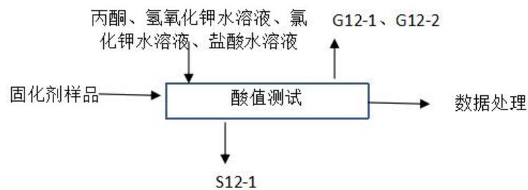
图 2-15 酸值实验流程图
