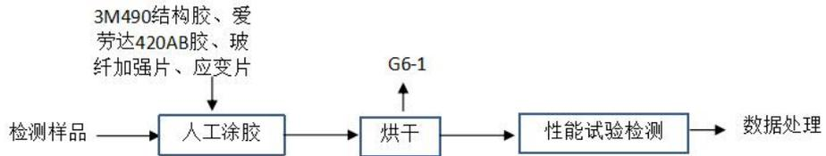
图 2-11 拉伸、压缩实验流程图
