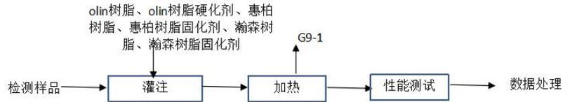
图 2-12 层剪断裂韧性实验流程图
