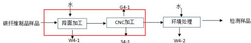
图 2-20 样品预处理流程图 (在建) 暂未投产工序
