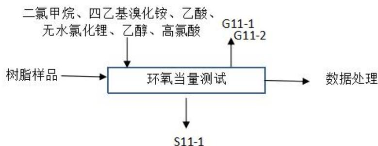
图 2-17 环氧当量实验流程图（在建）
