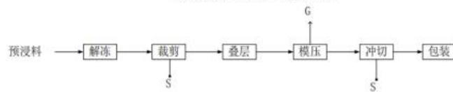
碳纤维模压板生产工艺流程图
