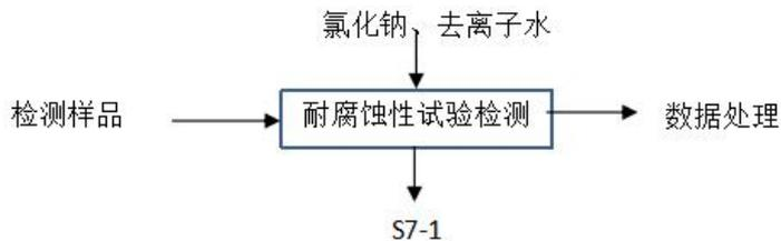
图 2-21 盐雾实验流程图 (在建)
