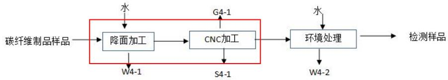
图 2-9 样品预处理流程图
