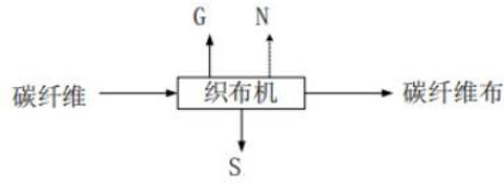
碳纤维布生产工艺流程图
