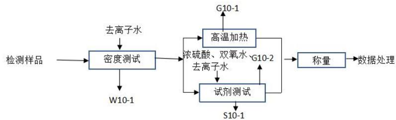
图 2-13 纤维含量测试流程图
